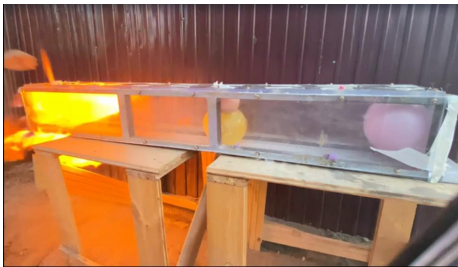
а) процесс поджига метановоздушной смеси
