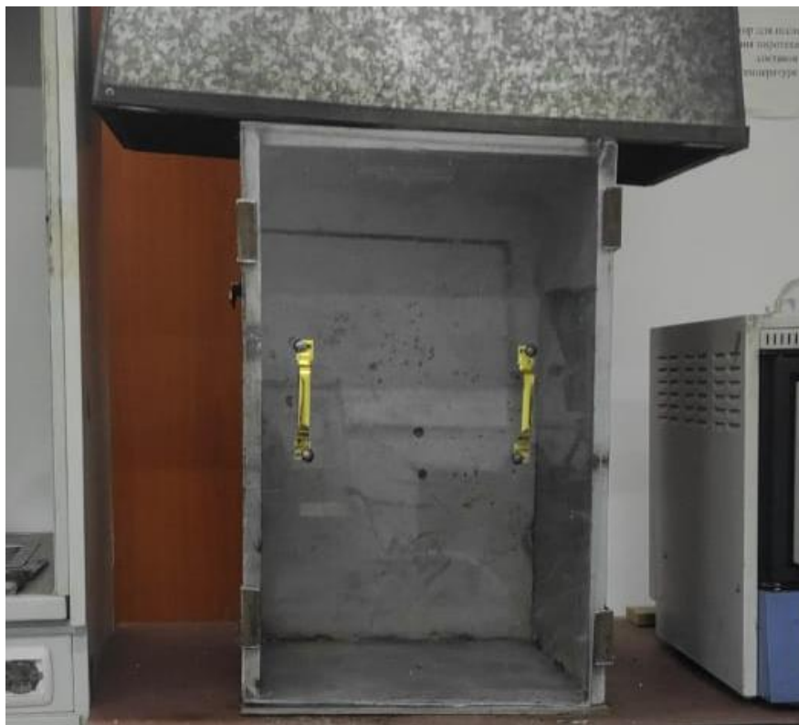
Рисунок 6 - Схема установки камеры сжигания и система, обеспечивающая получение дымовой составляющей газов
