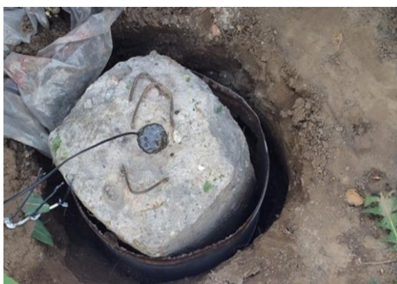
Рисунок 27 – Монолитный бетонный блок с зарядом ГХК
